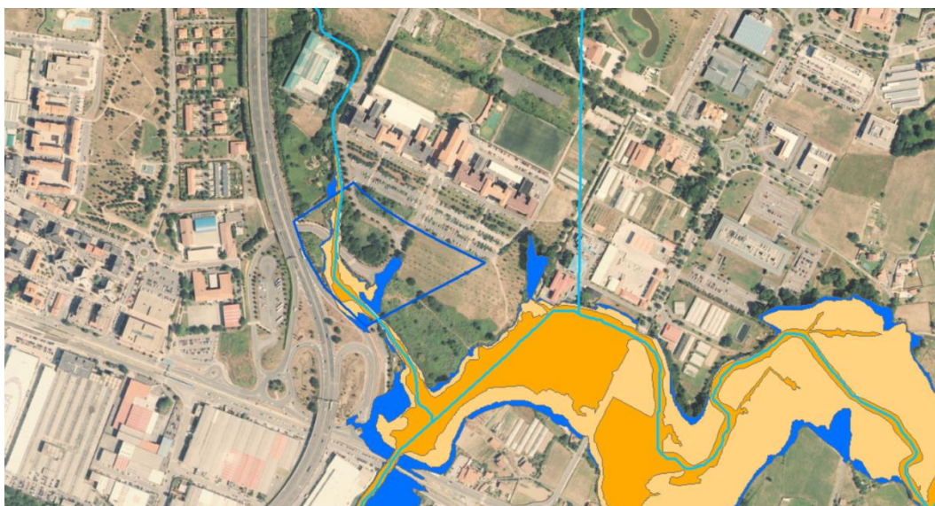
Imagen 13. Riesgo de inundación en el ámbito EL-SEM-02 Seminario y entorno.
